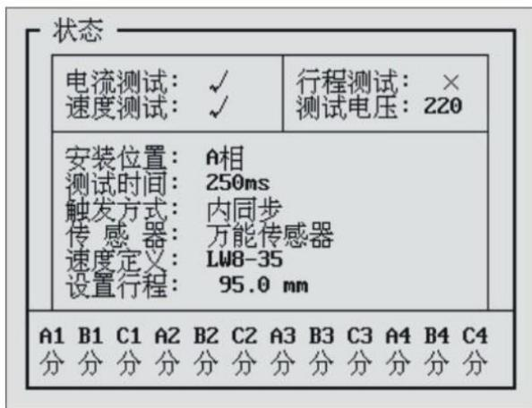
答：选择【测试】—【合闸测试】，仪器液晶显示屏的最下方有 12 断口的实时状态显示。屏幕显示如下图：
